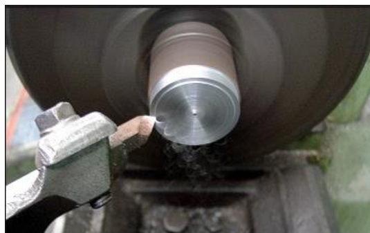
Figura 3. Proceso de refrentado. Tomado de https://goo.gl/os982N
