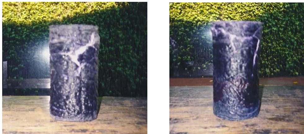
Figura 8 Tipo de Falla a Compresión, en cilindros sólidos de PEAD reciclado
