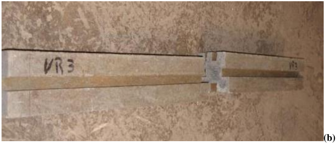
Figura 17 (a) y (b) Modo de falla en centro de luz de la viga durante ensayo a flexión en viga 1,16m de cimentación y remate con pestaña
