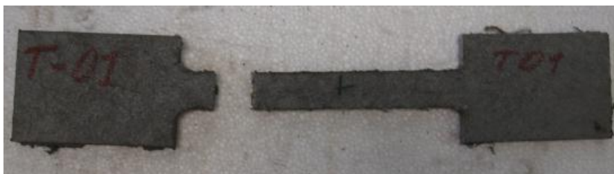
Figura 20 Modo de falla en extremo de muestra tipo probeta, ensayo a tensión.
