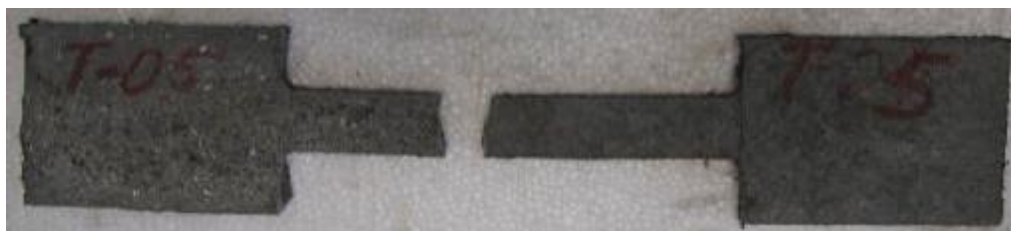
Figura 22 Modo de falla a 1/3 de la longitud de muestra tipo probeta, ensayo a tensión.
