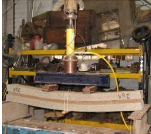
Figura 16 Flexión en viga de cimentación y remate con pestaña de 1,16m durante ensayo a flexión.
