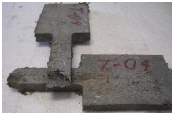
Figura 21 Modo de falla en centro de muestra tipo probeta, ensayo a tensión.
