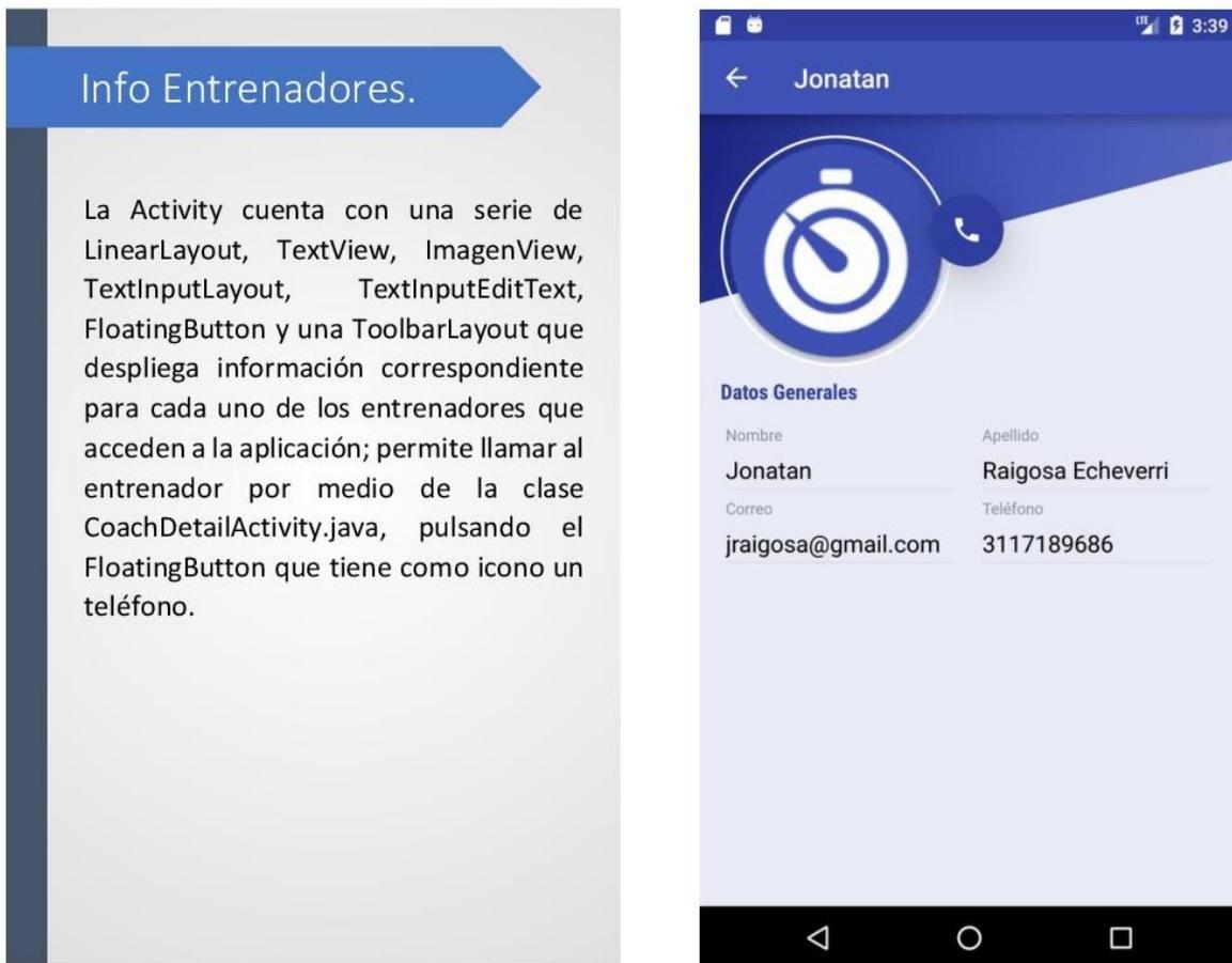
**Figura 31.** Diagrama de componente de la ventana "Info Entrenadores". Fuente: Cristian D. Soto y Jonatan Raigosa E.
