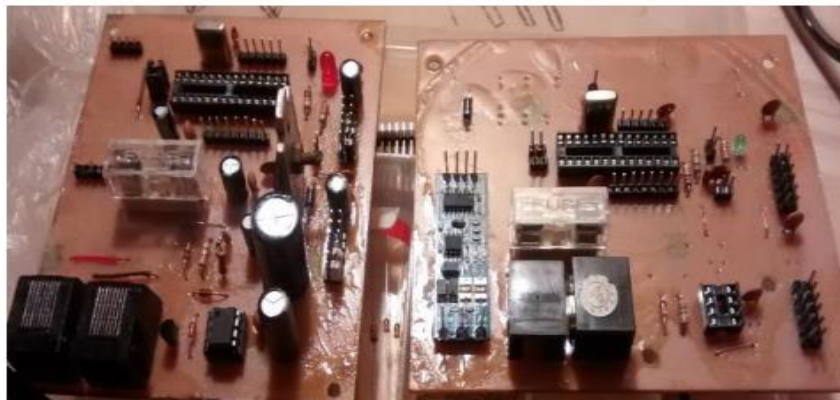
Ilustración 4 - Módulo del tablero de control
