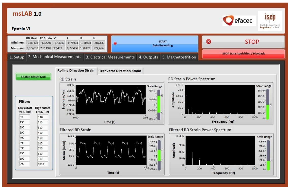
Figura 5.18: Sub-separador Rolling Direction Strain do separador Mechanical Measurements da aplicação msLAB.
