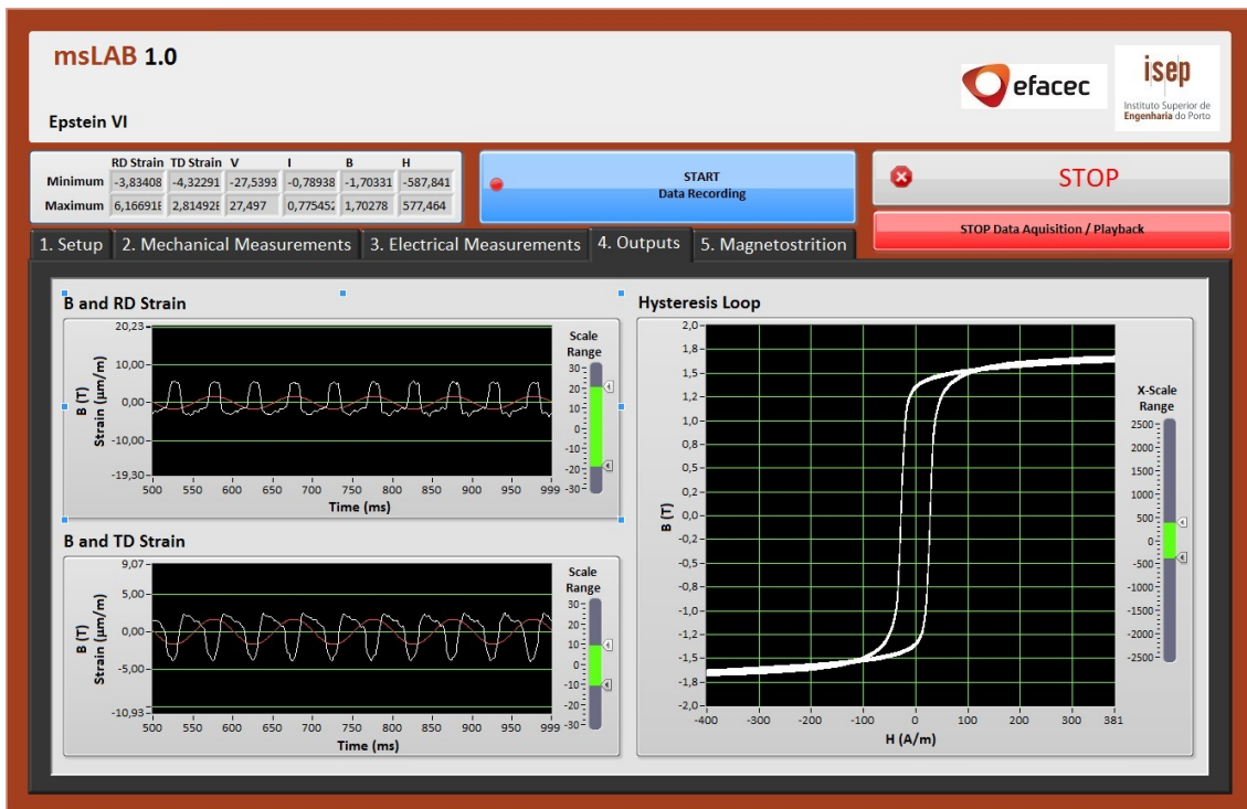
Figura 5.21: Separador Outputs da aplicação msLAB.
