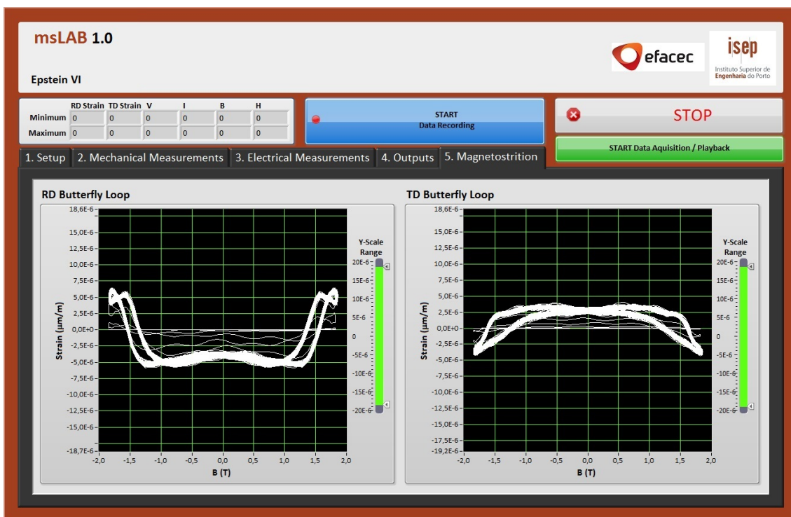
Figura 5.22: Separador Magnetostriction da aplicação msLAB.
