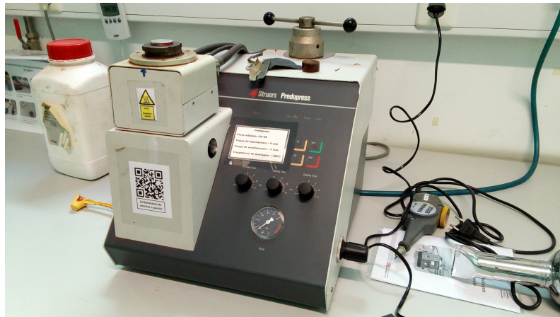
Figura 4.3: Máquina Struers Predopress utilizada para a montagem das amostras a quente.
