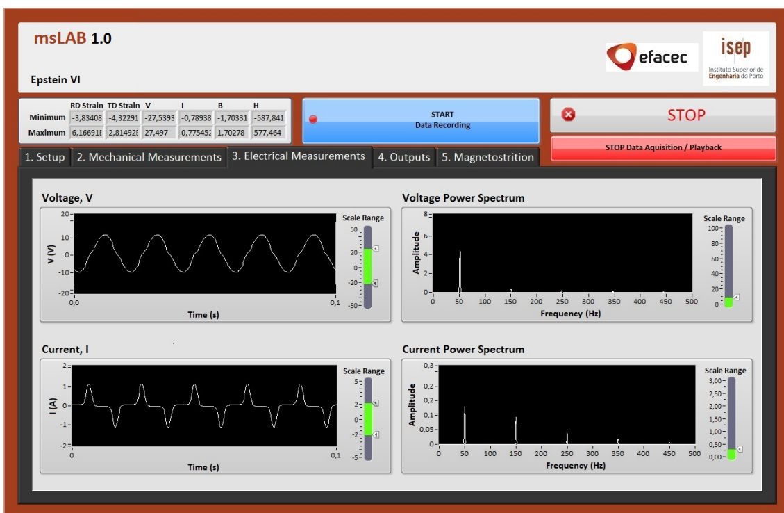
Figura 5.20: Separador Electrical Measurements da aplicação msLAB.
