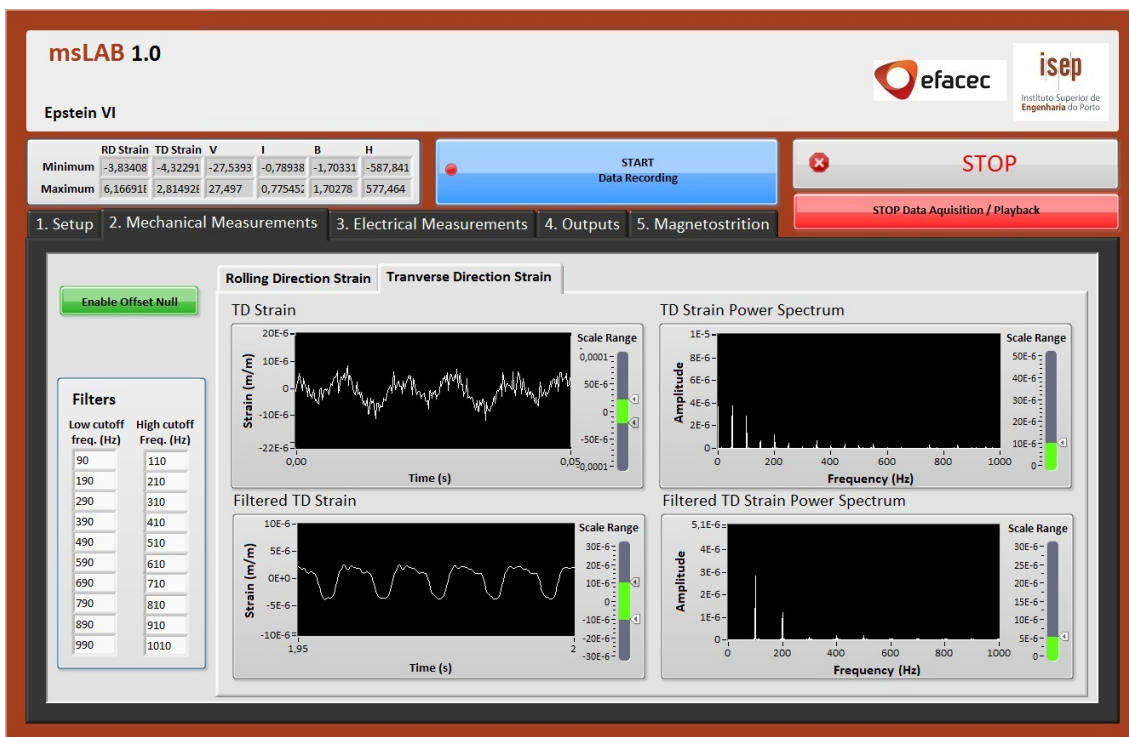
Figura 5.19: Sub-separador Tranverse Direction Strain do separador Mechanical Measurements da aplicação msLAB.
