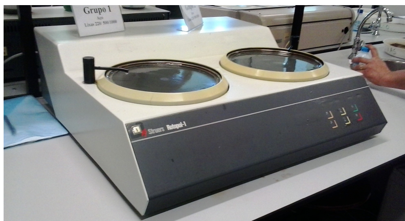
Figura 4.4: Máquina Struers Rotopol-1 utilizada para o lixamento das amostras.
