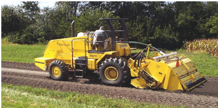
Figura 3.7 – Equipamento estabilizador: misturador de solo (fonte: Domingues, 2016).
