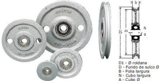
**Roldana em ferro fundido e aço sobre rolamento de esferas - Capacidade de 85 a 550 kg**
