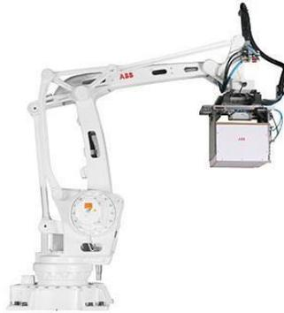
Figura 26 Robô ABB IRB460 com uma ferramenta tipo *Clamp* [16].
