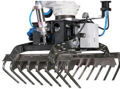
Figura 20 Exemplo de ferramenta tipo *claw* [15]
