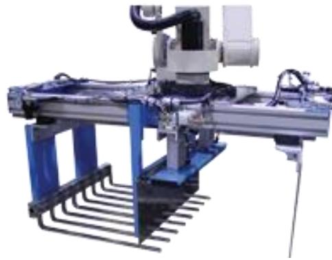
Figura 19 Exemplo de ferramenta tipo *fork* [11]
