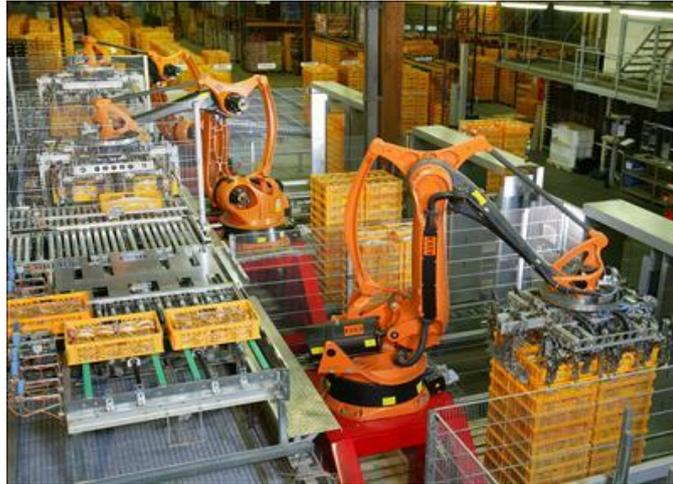
Figura 17 Robôs KUKA a paletizar caixas de pão [14]
