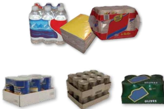
Figura 12 Exemplos de *bundle wrapping* (topo) e *shrink wrapping* (fundo) [11]
