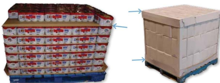
Figura 9 Dois exemplos de usos para placas separadoras [11]
