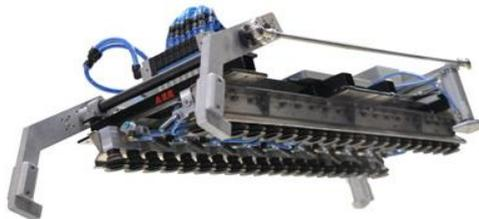
Figura 21 Exemplo de uma ferramenta de vácuo [16]
