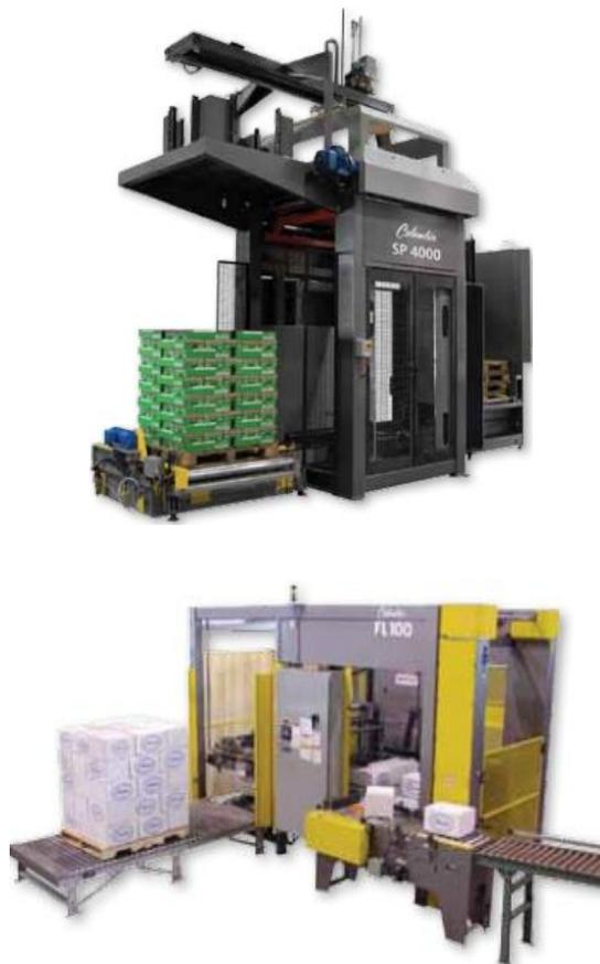
Figura 6 Exemplos de paletizadores tipo *high level* (em cima) e *floor level* (em baixo) [11].
