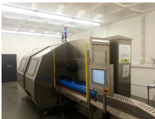
Figura 11: Equipamento de alta pressão (Hiperbaric 55, Hiperbaric, Burgos, Espanha).
