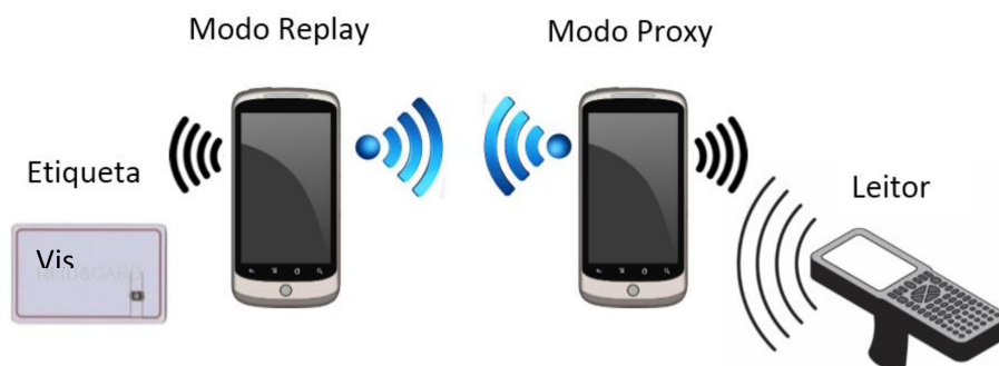
Figura 16 - Ataque de repetição utilizando dois Smartphones
