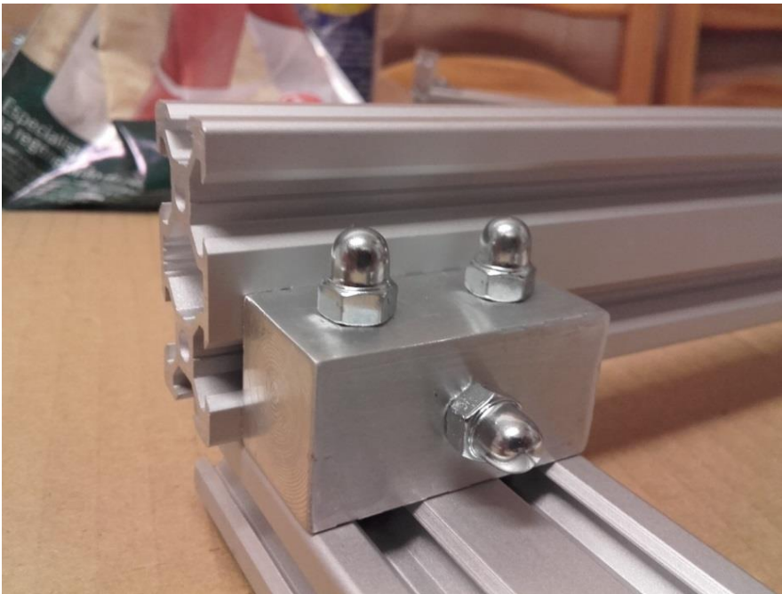
Figura 74b- Vista de pormenor da montagem dos parafusos de ligação nos perfis V-slot (tudo apertado).
