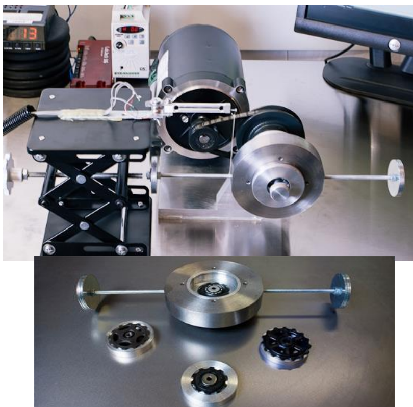
Figura 31- Equipamento de testes de rolamentos de carretos da empresa Friction Facts , adaptado de [40].
