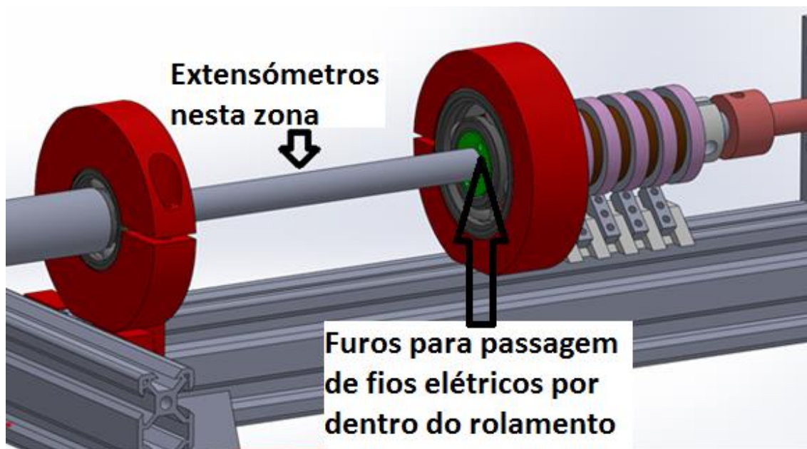
Figura 70- Local de montagem dos extensómetros.
