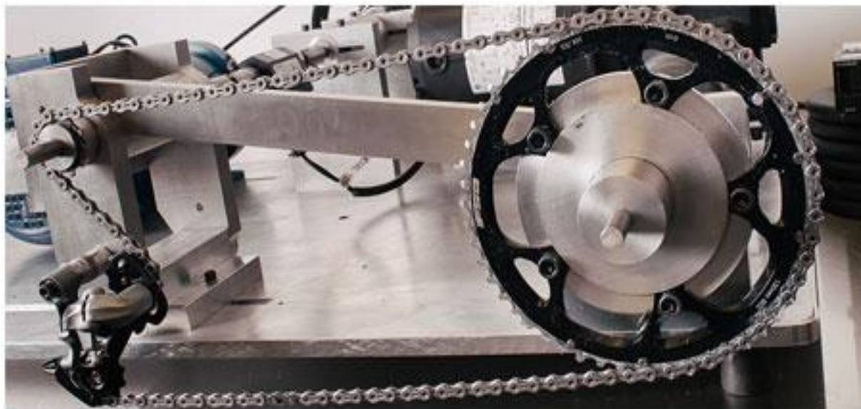
Figura 34- Equipamento para testes de atrito na transmissão em carga da empresa Friction Facts, adaptado de [43].
