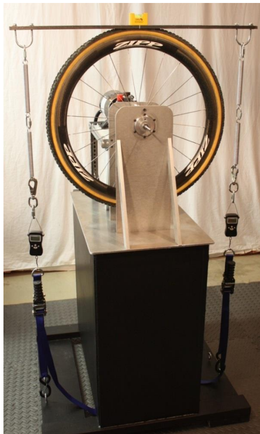
Figura 32- Equipamento para teste de rolamentos de roda da empresa Friction Facts , adaptado de [41].
