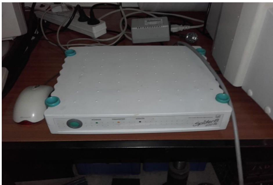
Figura 84- Sistema de aquisição de dado usado com a roseta ( HMB Spider8 ).
