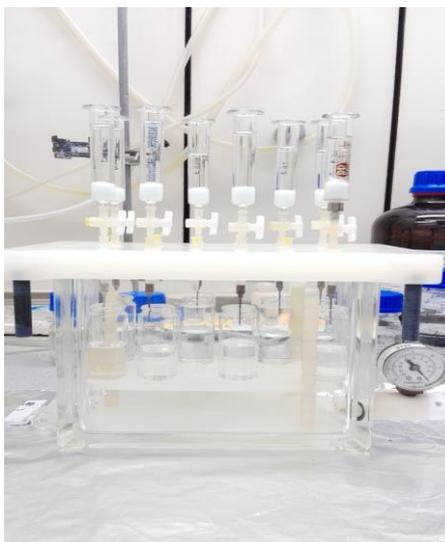
Figura 19. Instalação de MISPE utilizada para análise de galaxolide em águas.
