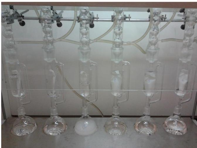
Figura 18. Processo de extração do *template* por Soxhlet.
