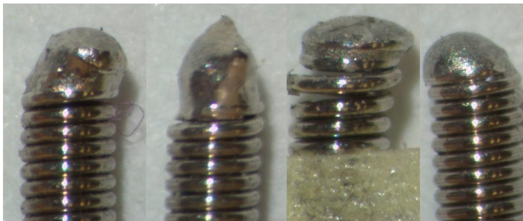
Obrázek 30: Nevyhovující spoje (200 \mu\text{A} – vzorky 16, 17, 27, 8), měřítko 25:1
