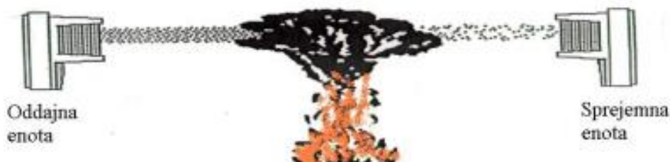
Slika 5.4: Shema delovanja žarkovnega javljalnika [18]
