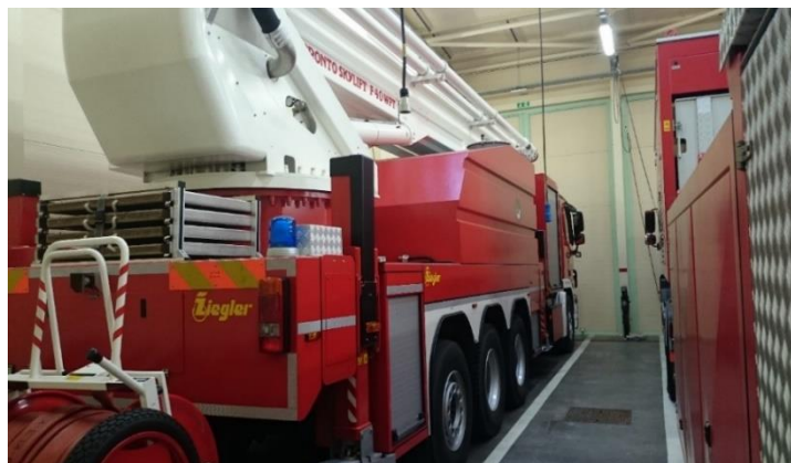
Slika 7.10: Gasilsko vozilo za gašenje velikih požarov v NEK (BRONTO SKYLIFT)
