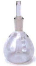
*Image d'un pycnomètre*
