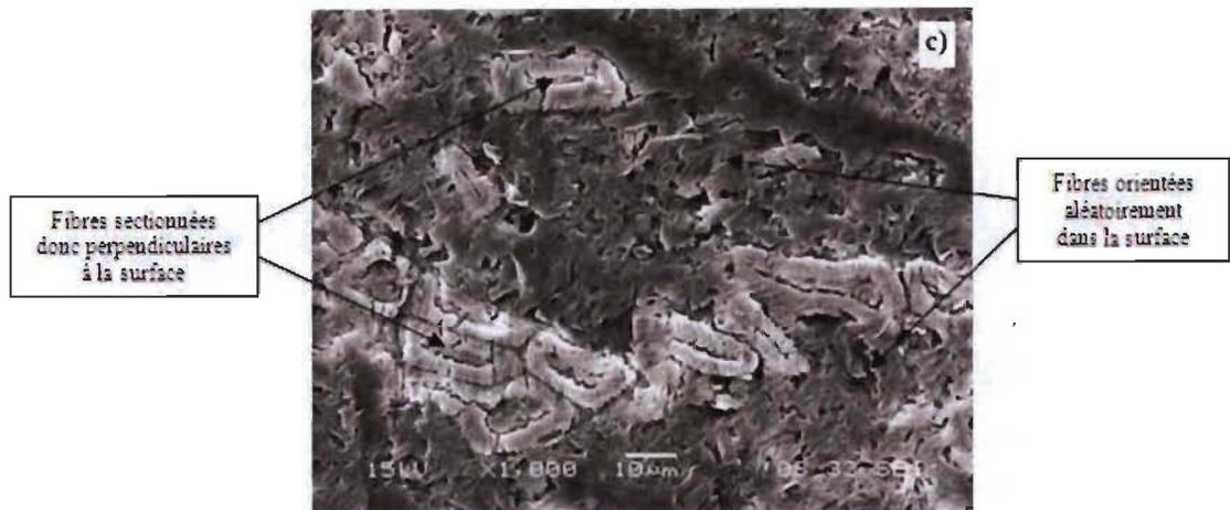
**Figure V. 20. Images MEB prises sur échantillon composite à 30% de fibres de bois**
