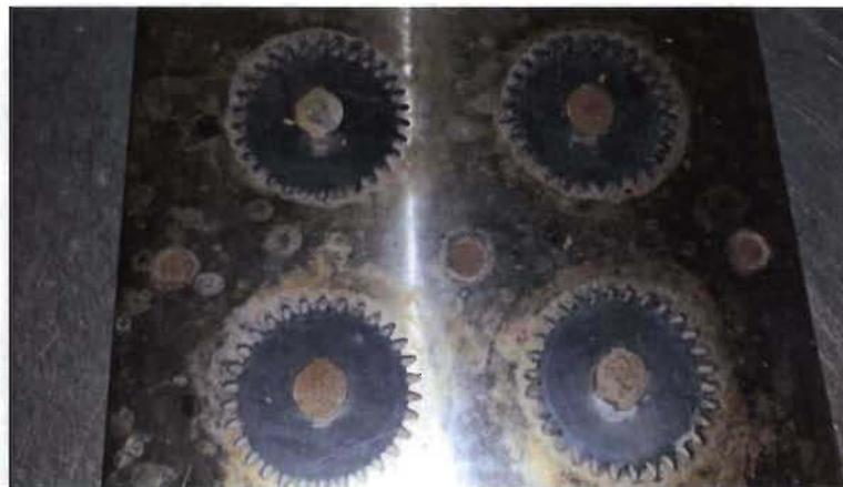
**Figure III. 9. Moule servant à la fabrication d'engrenages par thermocompression**
