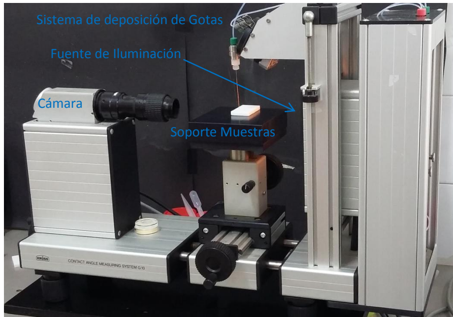
Figura 13. Imagen del goniómetro Krüss G20/DSA10, empleado en el transcurso de esta tesis.
