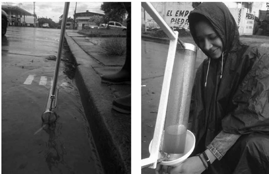
Figura 10. Recolección de muestras mediante captador DH3.
