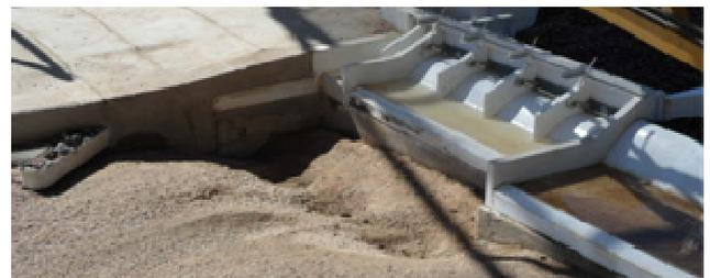
Fig. 6: Foso de erosión aguas abajo del dique móvil. Caudal prototipo: 900 m<sup>3</sup>/s
