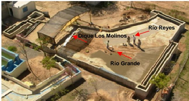
Fig. 3: Vista general del modelo físico construido en el LH-UNC.
