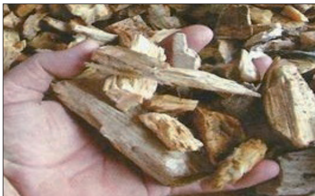
Figura 2: Presentación de chips de madera provenientes fuentes mixtas implantadas destinados a combustible en la industria yerbatera.
