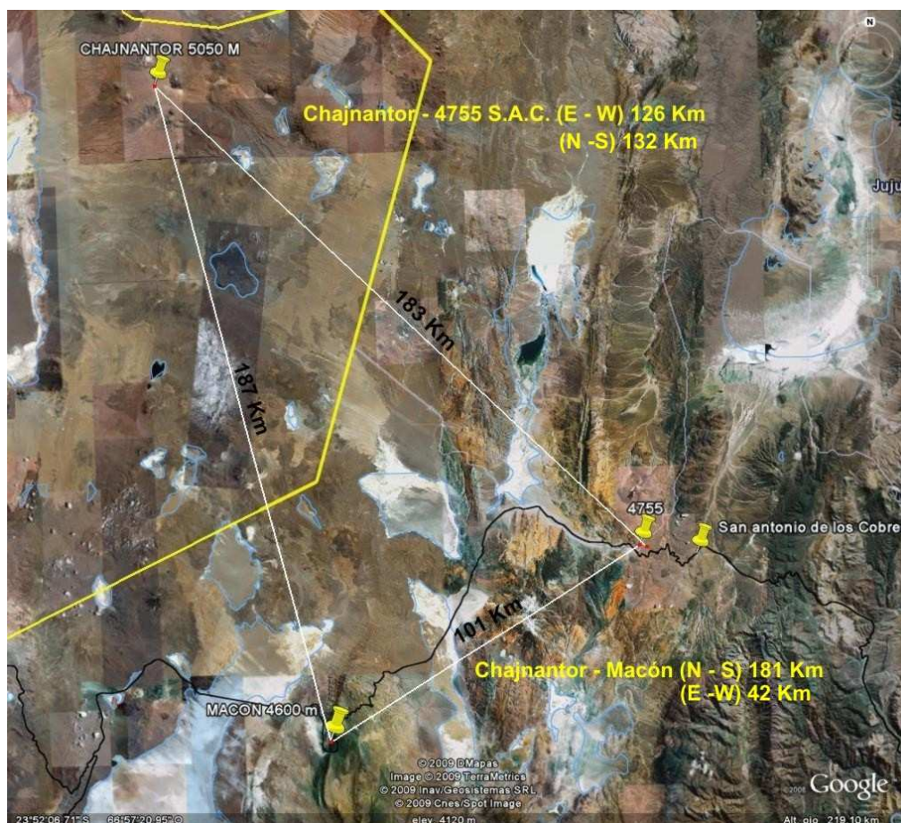
Figura 1. Ubicación relativa de dos de los posibles sitios para instalar la antena del proyecto LLAMA, respecto del interferómetro ALMA. Las distancia norte-sur y este-oeste entre los sitios y ALMA se encuentran indicadas.
