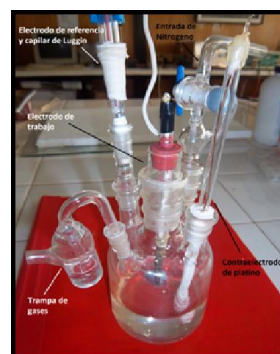
Figura 2. Celda electroquímica convencional de tres electrodos.
