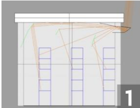
1- Estudio de rayos de luz natural redirigidos hacia los estantes portafrascos con cultivo. 2- Estudio en modelo a escala de luz natural a distintos horarios y meses. 3- Colocación del sistema diseñado. 4- Foto de la sala de propagación agámica.
