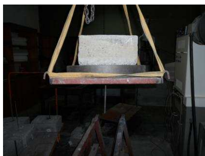
Figura 2: Bloque de hormigón sobre disco metálico de apoyo.
