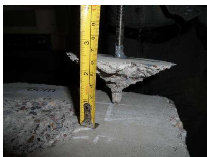
Figura 5: Falla del anclaje por arrancamiento del cono de hormigón.
