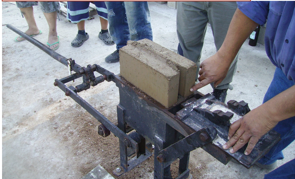
FIGURE 1. The fabrication of soil-cement blocks in Monte Terrabusi, Mar del Plata. A manual press of the CINVA-RAM type with a matrix to make compound blocks with inner bonding. (Credit: Fernando Cacopardo). / Fabricación de bloques de suelo-cemento en Monte Terrabusi, Mar del Plata. Prensa manual del tipo CINVA-RAM con matricería para bloque intertrabado. 2013. (crédito: Fernando Cacopardo).
