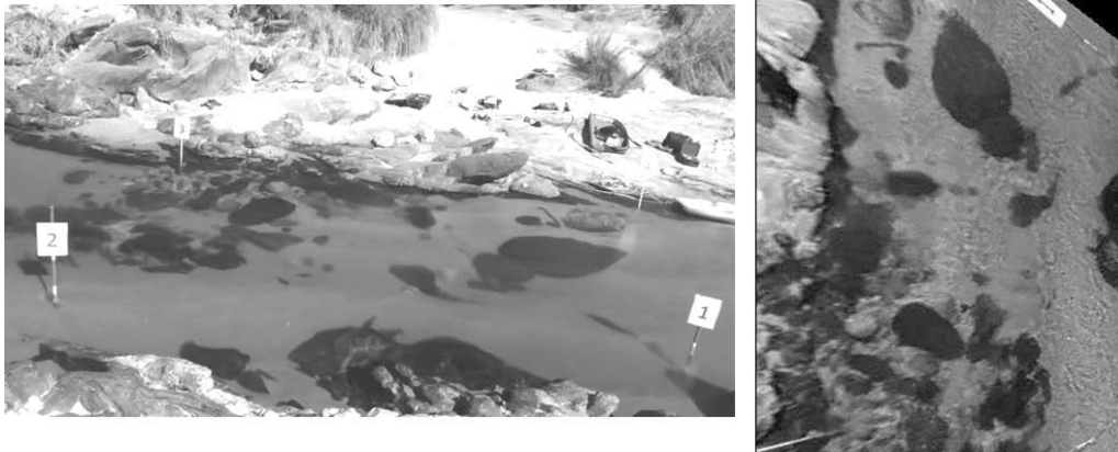
Figura 6. Ejemplo de rectificación digital de la zona de interés del río San Antonio al primer tramo: A la izquierda imagen original de la zona de interés con los 4 puntos de control, a la derecha la misma imagen rectificada en un plan ortogonal. Para disminuir el costo computacional, en el post-procesamiento, una imagen única es rectificada para poder graficar encima los resultados rectificados.
