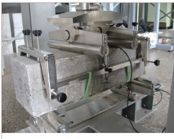
■ Figura 2. A la izquierda vista de los dispositivos de ensayo. A la derecha la configuración de carga y curva del HRF.
