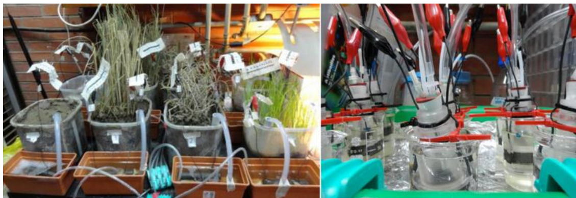
Figura 2: Diseño experimental (set-ups) utilizado. En el panel de la izquierda, varias de las P-MFCs construidas; de izquierda a derecha se observa suelo (control), Spartina , Salicornia , y Oryza . En el panel de la derecha, celdas de combustible basadas en algas.
