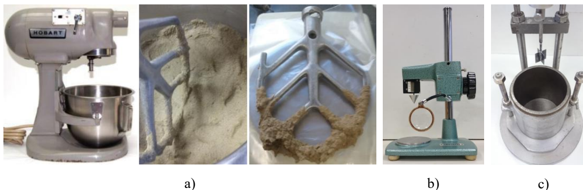
Figura 2 – Apparecchiature utilizzate per la prova di miscelazione (a), fall cone (b) e scissometrica (c).
