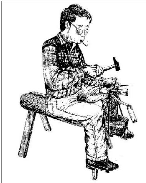
Figura 14: Dibujo que reproduce la tarea del herrero sentado en el caballete "picando" una hoz. En este caso es una simulación para la que se ofreció Ramón Esteban (propietario de caballete y del yunque de hueso actual). Por J. Martí y R. Sala.
