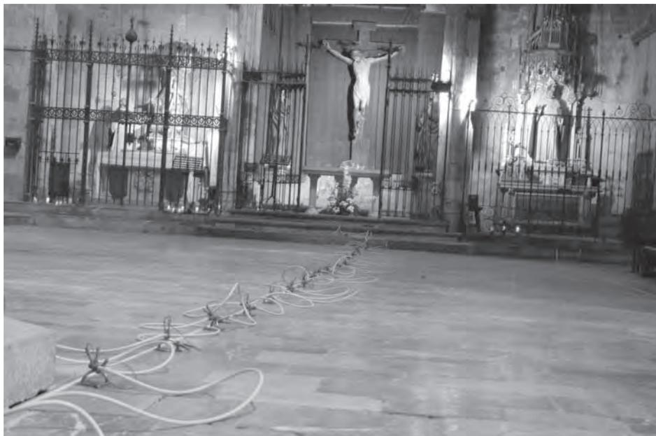
*Figura 7. Proceso de obtención de datos mediante la tomografía de resistividad eléctrica.*
