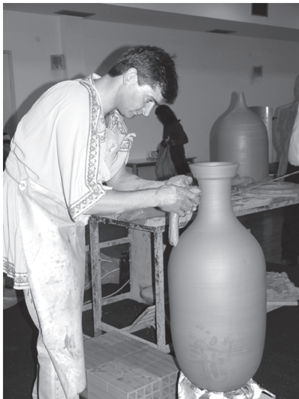
Figura 2. Procés de fabricació d'una àmfora Haltern 70 (Simposi de Peniche, Portugal, 2006).
