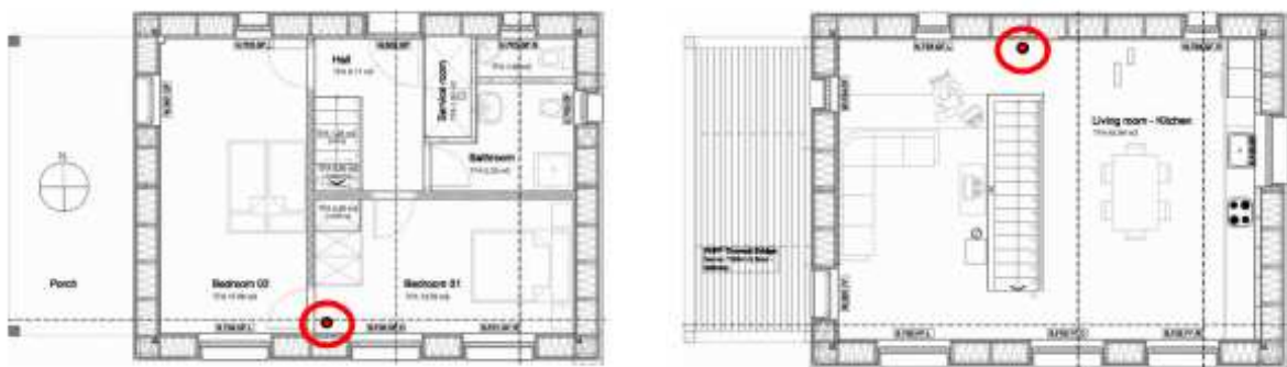
Figura 6.01: Localización de los sensores en PB y P1 (Fuente: Progetic)
