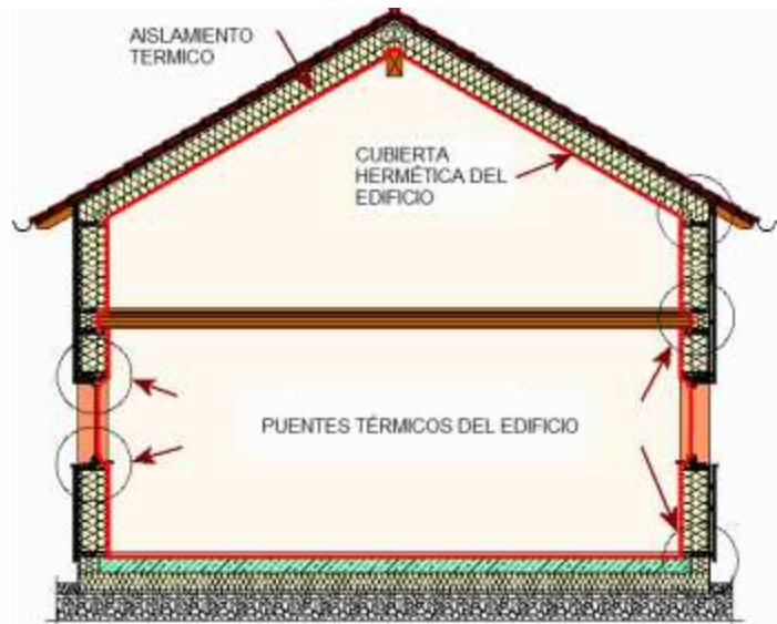
Figura 1.05: Detalle aislamiento térmico ( Fuente: Fenercom)
