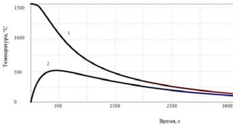
Рис. 3. Зависимость температуры отливки (1) и стенки кокиля (2) от времени охлаждения отливки без охлаждения
