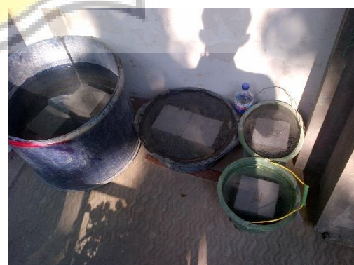
Proses Perawatan atau Curing
