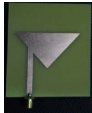
Gambar 10. Fabrikasi antenna mikrostrip tunggal bentuk segitiga terbalik [2]
