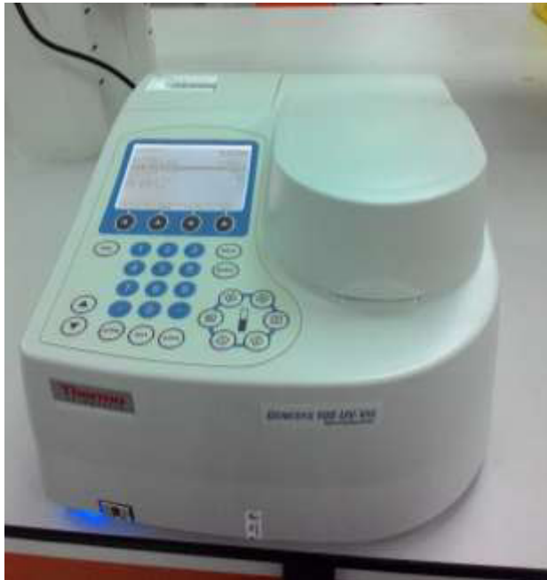
Fig. 2. Genesys 10 UV-Vis Spectrometer.
