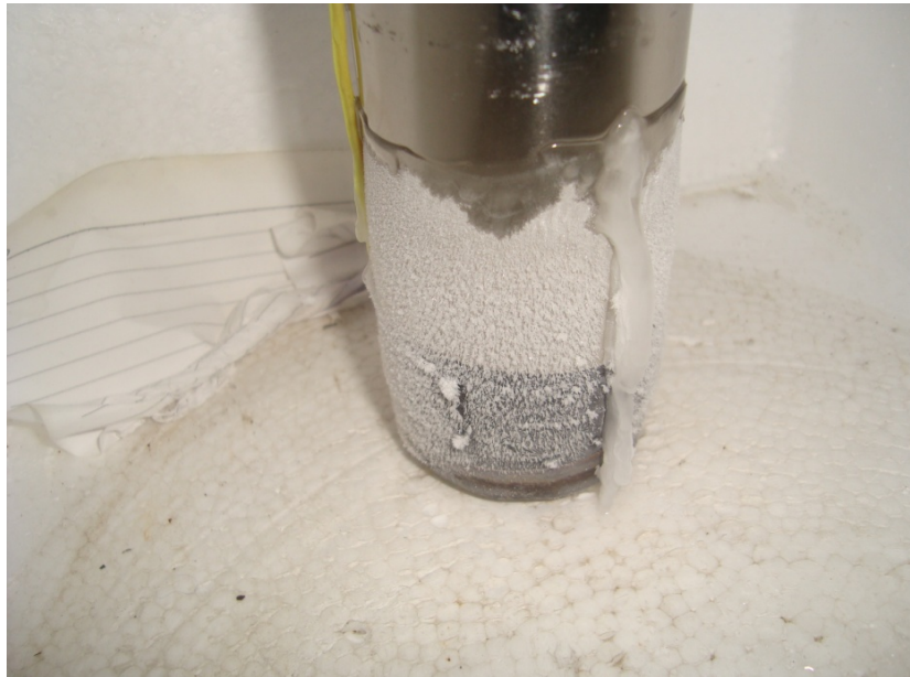
Bunga es pada evaporator selama proses absorpsi
