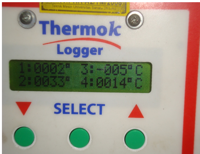
Suhu terendah pada evaporator mencapai -5^{\circ}\text{C}
