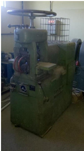
Fig. 5: a) Laminadora mecánica; b) Vista de los rodillos de laminación
