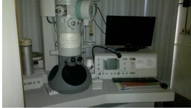
Fig. 19: Microscopio Electrónico de Transmisión utilizado para la observación de muestras de la aleación
