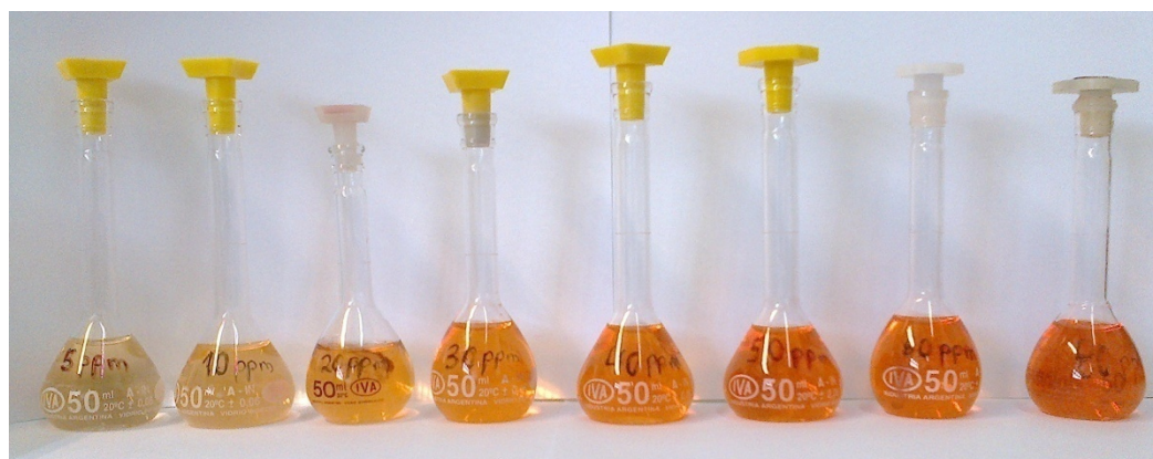
Figura 10. Soluciones de Doxorubicina usadas para calibrar el espectrofotómetro de UV/Vis.
