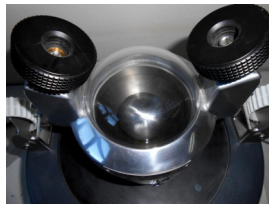
Fotos del nuevo molino de baja energía: (a) cámara de molinda en el molino. (b) vista superior de la cámara de molinda, en la que se observa la bola.
