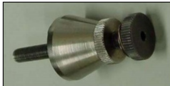
Figura 8. Portamuestras de Microscopio electrónico SEM donde se colocaron sobre una cinta adhesiva de grafito directamente las muestras de microesferas
