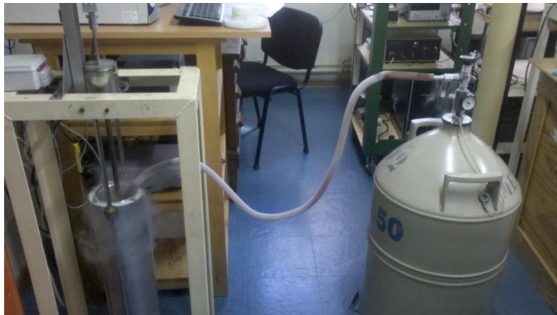
Fig. 9: llenado del termo de la máquina de medición de resistividad eléctrica con nitrógeno líquido para medición a bajas temperaturas
