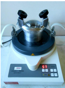
Fotos del nuevo molino de baja energía: (a) cámara de molinda en el molino. (b) vista superior de la cámara de molinda, en la que se observa la bola.
