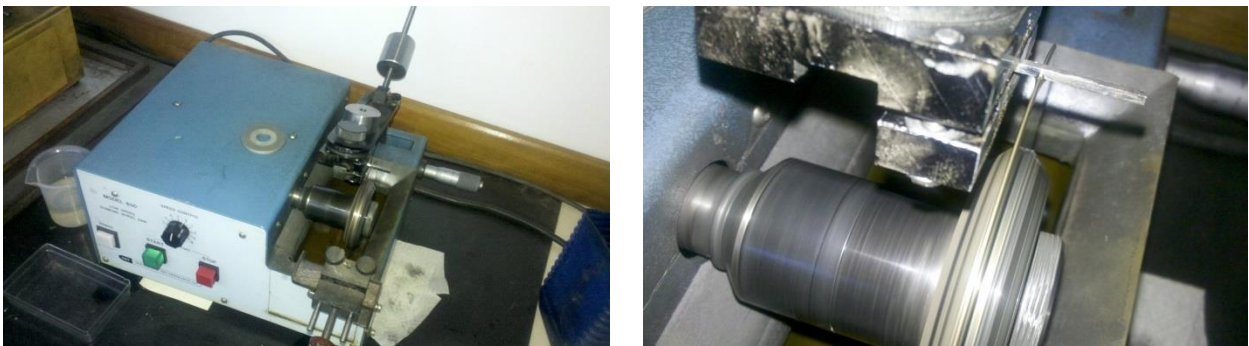
Fig. 7: Cortadora ISOMET contando muestras para ensayos
