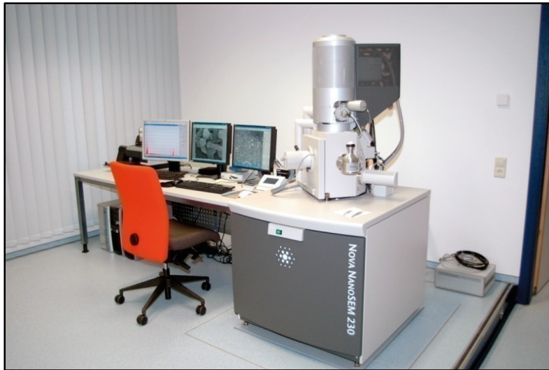
Figura 7. Microscopio electrónico SEM FEG NovaNano 230 perteneciente al Departamento de Caracterización de Materiales
