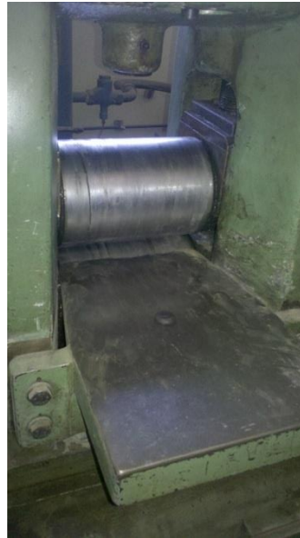
Fig. 5: a) Laminadora mecánica; b) Vista de los rodillos de laminación
