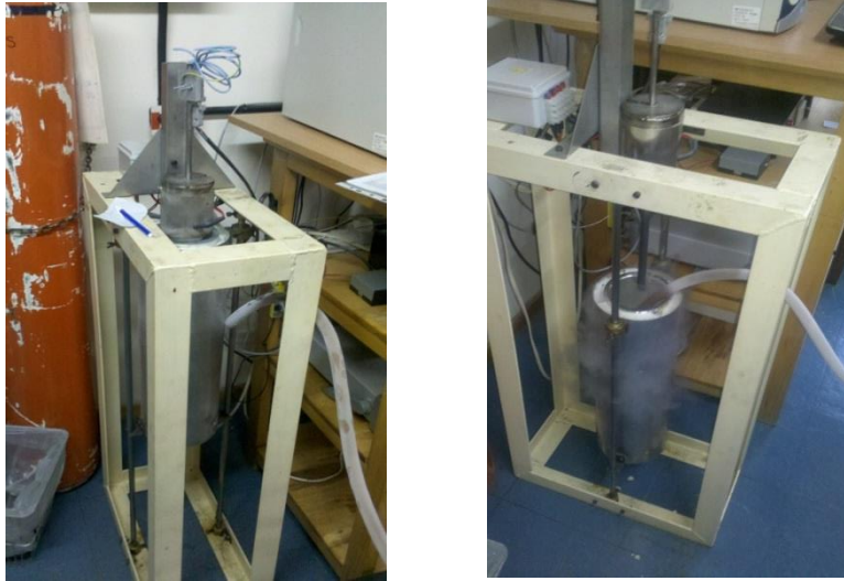
Fig. 8: máquina de ensayo de resistividad eléctrica
