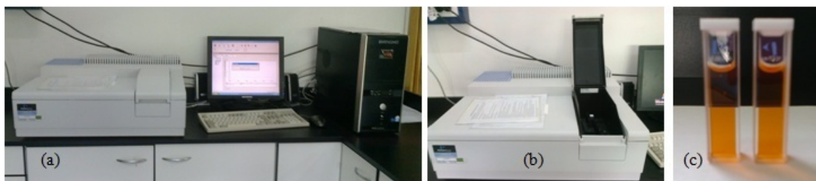
Figura 9. (a) y (b) Espectrómetro de UV/Vis marca Perkin Elmer modelo Lambda 35, perteneciente a la División de Cinética Química. (c). Celdas de cuarzo del equipo de Espectrofotometría UV/Vis.
