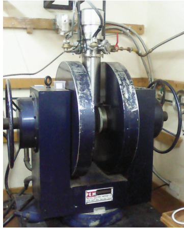
Figura 2.12: Equipo para mediciones de Resistencia a distintas temperaturas y campos magnéticos aplicados.
