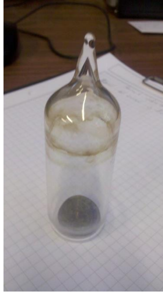
Fig. 4: Botón de la aleación encapsulado en ampolla de cuarzo llena de argón
