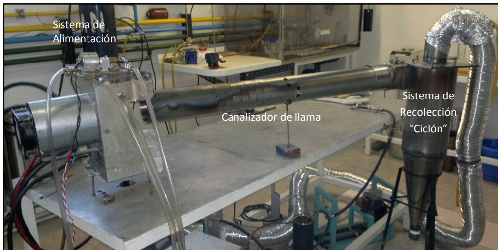
Figura 5. Esquema del sistema usado para obtener las microesferas.
