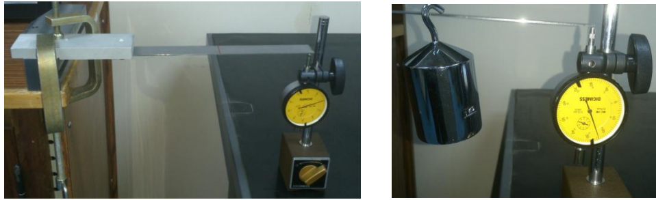
Figura 12. Sistema de calibración del fleje con detalle del palpador y la deflexión producida por una pesa calibrada.
