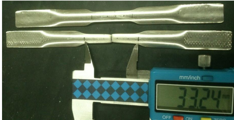
Figura 29. Determinación del largo de la sección calibrada posterior al ensayo.
