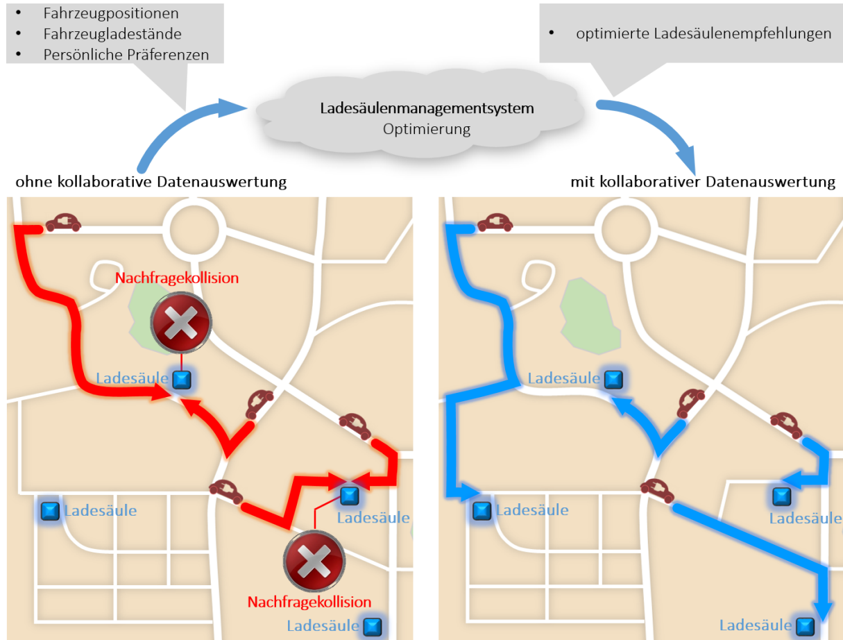
Abbildung 2: Ziel eines kollaborativen Ladesäulenmanagementsystems
