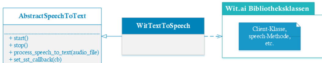
Abbildung 66: Komponenten zur Umwandlung von Sprachdateien zu Text. [Quelle: Eigenmaterial]
