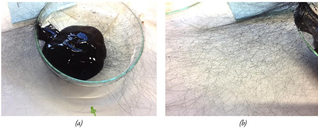
*Abbildung 4.28:* Vorversuche zu Erzeugung eines ungeordneten Gewebes aus dünnsten PVA-Fäden. Abb. (a) zeigt die akkumulierten Tropfen in einem grossen, noch feuchten Blob verbunden und Abb. (b) die verwobenen Fäden, die freihängend trocken.
