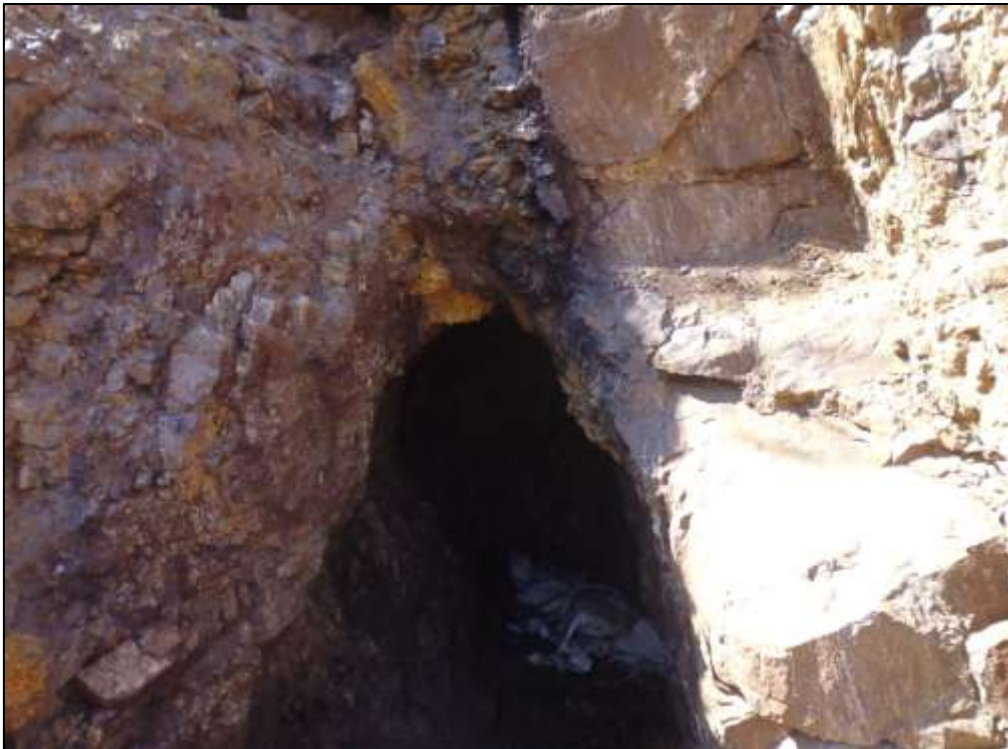
Figura 72: Bocamina de beta 1, en la cual se muestra halos de oxidación, entre una roca circundante Calcárea, e hidróxido, con contenido aurífero.
