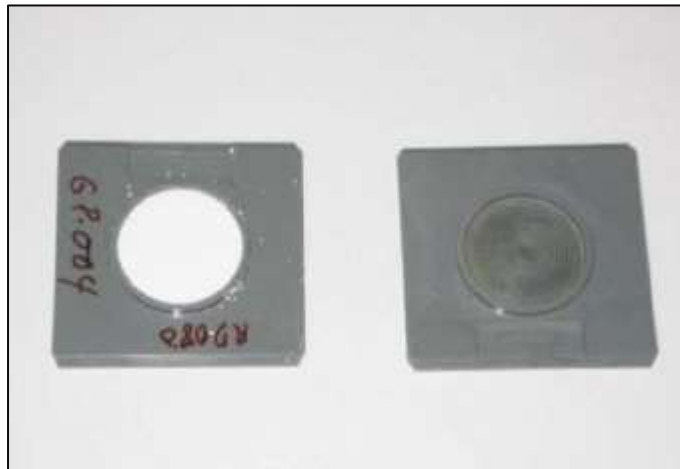
Figura 1: Portamuestras para polvo en difracción de rayos X, con y sin polvo cristalino.
