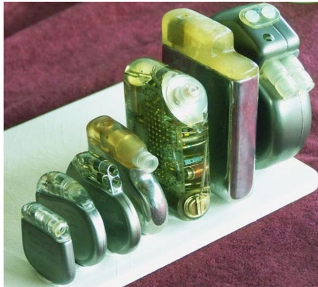
**Abb. 2** ► Größenentwicklung der Pacemaker (PM)-Aggregate seit den 1970er Jahren: zweiter PM von rechts ist erster Schrittmacher mit Lithiumbatterien. Erster von rechts ist größter, dritter von rechts kleinster PM mit Quecksilber-Zink-Batterien. (Foto: Werner Imrich)
