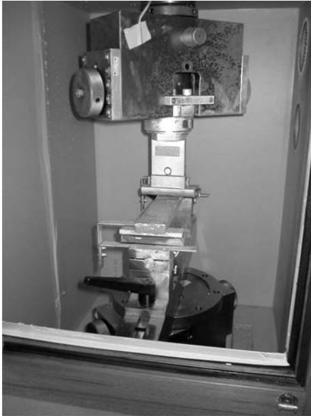
Abb. 1 Prüfstand mit Klimakammer Fig. 1 Test setup with climate box
