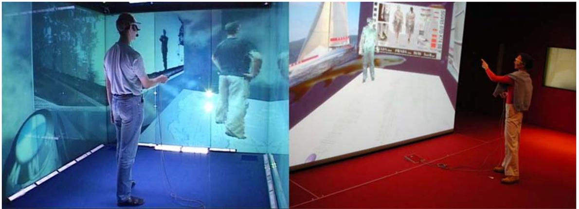
**Abb. 1 Die zwei blue-c Portale in Aktion: Links ist das dreiseitige CAVE-System mit drei aktiven Projektionswänden und aktiver LED-Beleuchtung abgebildet. Das Bild rechts zeigt das einfachere PowerWall-System mit einer herkömmlichen Projektionswand. Beide Systeme akquirieren ein dreidimensionales Video der Benutzer mit insgesamt 16 Kameras und ermöglichen Stereo-Projektionen**
