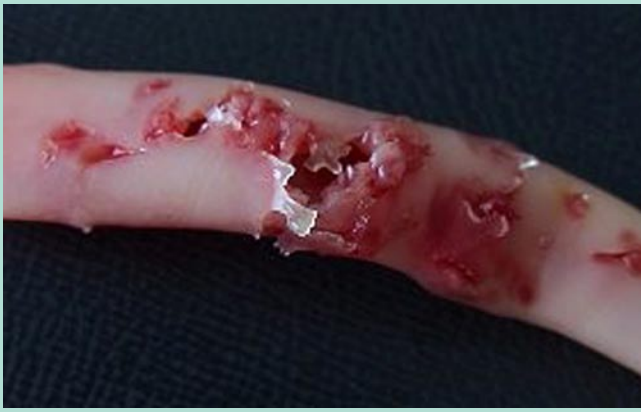
Abb. 6 ▲ Durch Punktionen geschädigter PTFE-Graft nach 1 Jahr Gebrauch
