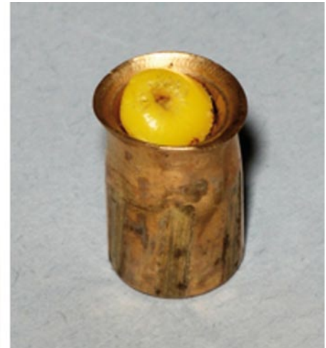
Abb. 7 ▲ Mitte : Deformation des Action-4-Geschosses bei einer Geschwindigkeit von 365 m/s. Links und rechts : gleicher Geschosstyp nach einem Steckschuss bzw. Körperdurchschuss
