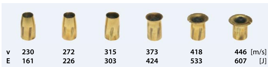
Abb. 5 Action 5: Abhängigkeit der Geschossdeformation von der Auftreffgeschwindigkeit bzw. der Auftreffenergie
