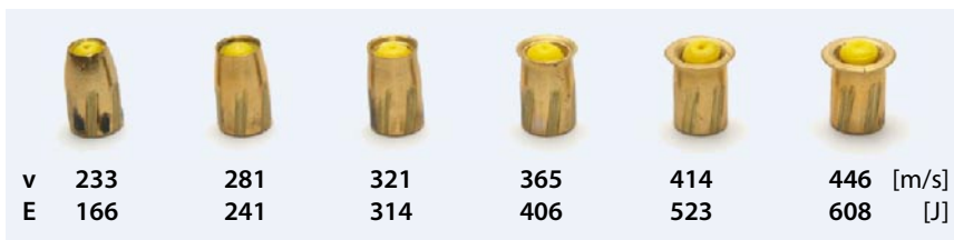
Abb. 2 Action 4: Abhängigkeit der Geschossdeformation von der Auftreffgeschwindigkeit bzw. der Auftreffenergie
