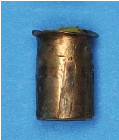
Abb. 7 ▲ Mitte : Deformation des Action-4-Geschosses bei einer Geschwindigkeit von 365 m/s. Links und rechts : gleicher Geschosstyp nach einem Steckschuss bzw. Körperdurchschuss
