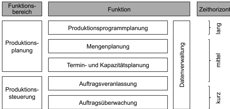
Abb. 2: Klassische Funktionsstruktur eines PPS-Systems (in Anlehnung an [Hackstein 1989, S. 5])
