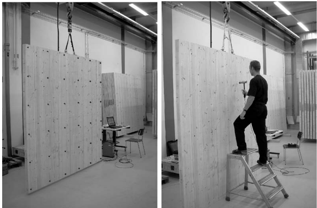
Abb. 3 Hängende Platte mit gleichmäßigem Raster von 6 \times 6 Punkten Fig. 3 Hanging panel with Cartesian grid of 6 times 6 equally spaced points
