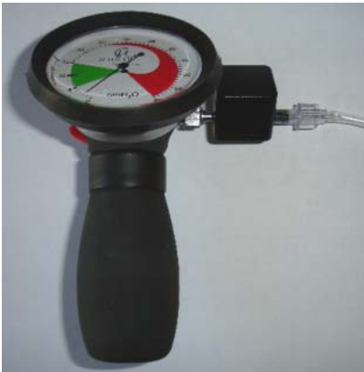
Abb. 2 ▲ Cuffmanometer mit Überdruckventil zur oberen Begrenzung des Cuffdrucks auf maximal 20–22 cmH 2 O (Microcuff GmbH, Weinheim, Germany)
